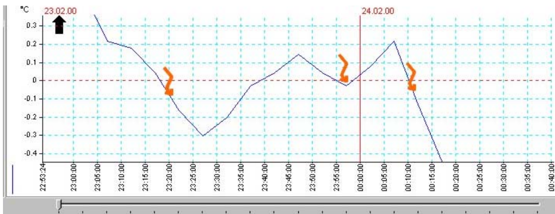
Abbildung 29 Beispiel für Alarmauslösung bei Unterschreitung des Wertes 0°C. Alarm wird nur im Moment der Unterschreitung ausgelöst. Die Abtastperiode beträgt in diesem Beispiel 5 Minuten.
