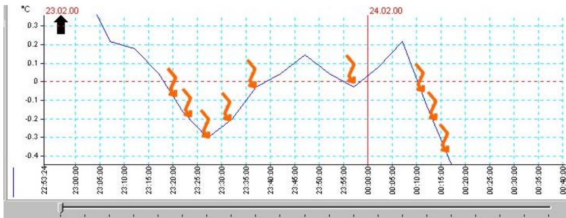
Abbildung 30 Beispiel für Alarmauslösung bei Unterschreitung des Wertes 0°C. Alarm wird bei jedem Messwert ausgelöst, der den Grenzwert unterschreitet. Die Abtastperiode beträgt in diesem Beispiel 5 Minuten.
